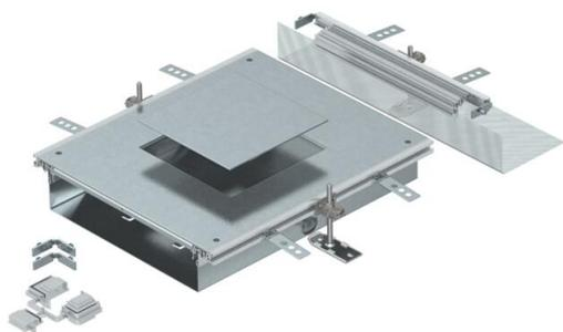
Ampliación de canal lista, para montar una unidad portamecanismos de tamaño 4. Está compuesta por una base de canal (con perfiles laterales y de apoyo en el pavimento), una tapa de canal con abertura de montaje cerrada de forma ciega y un final de canal. Se suministra con 3 ángulos de fijación de altura regulable, 3 piezas de anclaje y una pieza angular. Tamaño de la abertura de montaje apropiado para montar una unidad de montaje cuadrada de tamaño nominal 4.
