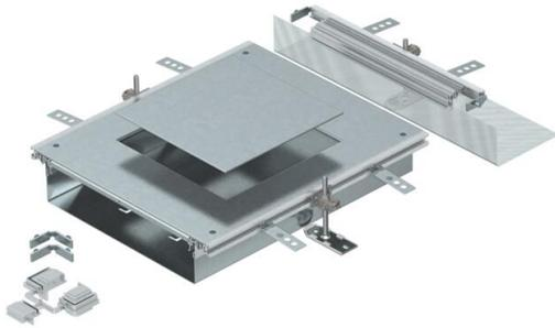
Ampliación de canal lista, para montar un conjunto portamecanismos de tamaño 9. Está compuesta por una base de canal (con perfiles laterales y de apoyo en el pavimento), una tapa de canal con abertura de montaje cerrada de forma ciega y un final de canal. Se suministra con 3 ángulos de fijación de altura regulable, 3 piezas de anclaje y una pieza angular. Tamaño de la abertura de montaje apropiado para montar una unidad de montaje cuadrada de tamaño nominal 9/55.
