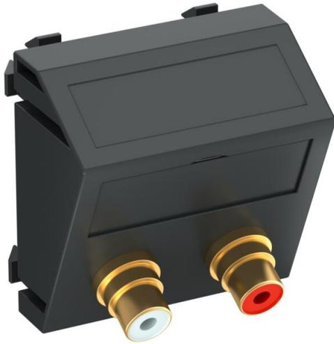
Soporte multimedia con dos conectores cinch para audio R/L, salida transversal de cable, con campo identificativo, dos conectores cinch (RCA) con conexión por soldadura, código cromático rojo/blanco. Placa de soporte con enganche, apropiada para el montaje vertical y horizontal en el entorno del sistema.
