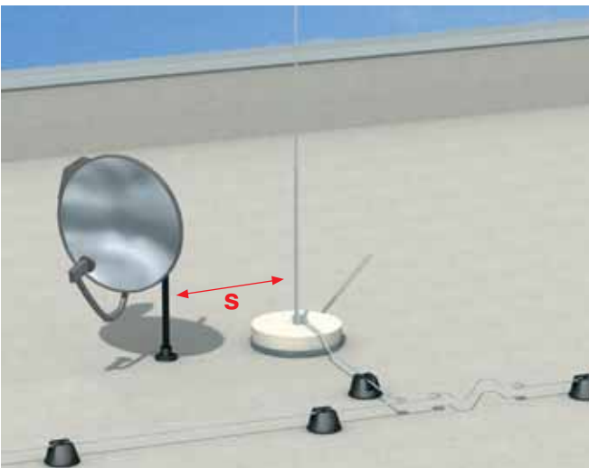
Yıldırımlık direği ile uydu anteni arasındaki doğru ayırma aralığı s
