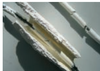
Огнестойкий кабель с изолирующим слоем золы
