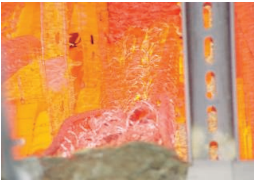
Испытание в печи: повторное прокаливание несущей конструкции
