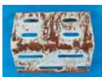
552 horas em névoa salina Pré-galvanização (Sendzimir)
