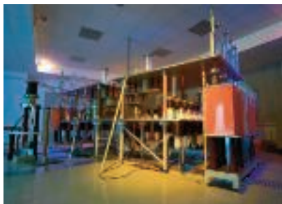
Gerador de corrente de raio
