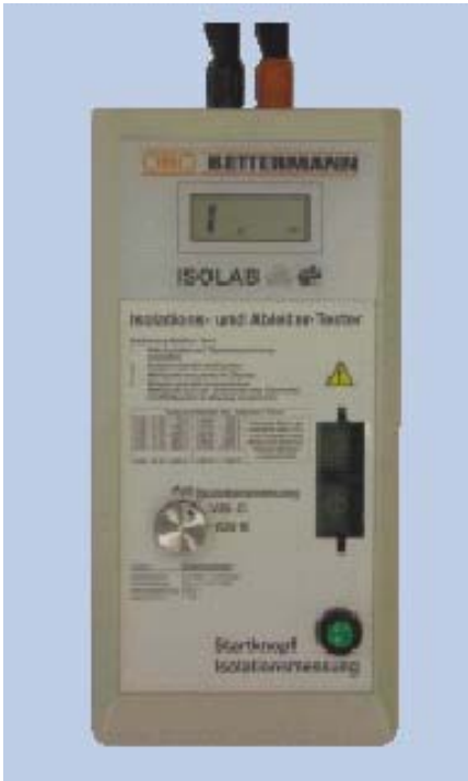
Figura 8: Aparelho de verificação do isolamento
