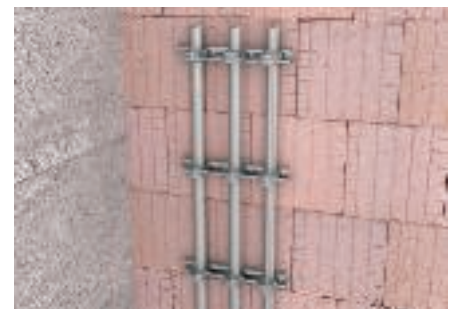
Zamontowane obejmy U pionowo na ścianie z pojedynczym, podwójnym i potrójnym obciążeniem.
