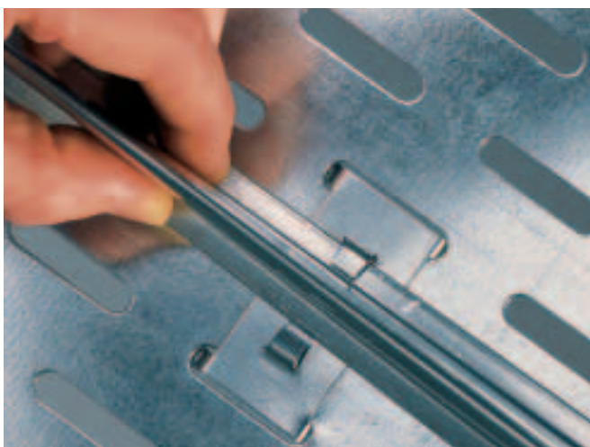
Scheidingsschot »TSG 60/S« plaatsen: licht samendrukken en inklikken
