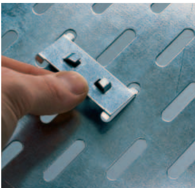
Klemstuk »KS MKS/SKS« in een MKS-kabelgoot plaatsen (afstand: ca. 3 stuks/lengte)
