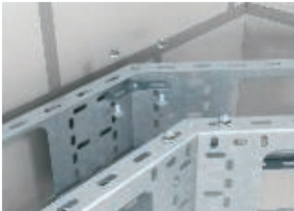
Eenvoudige vervaardiging van bochten met scharnierverbinders type SV. Hiertoe moeten de zijkenen op maat worden gesneden.
