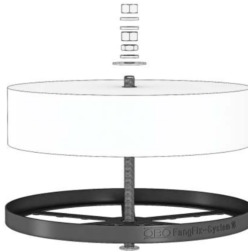
Bild 27 Betonsockel auf Kantenschutz montieren
