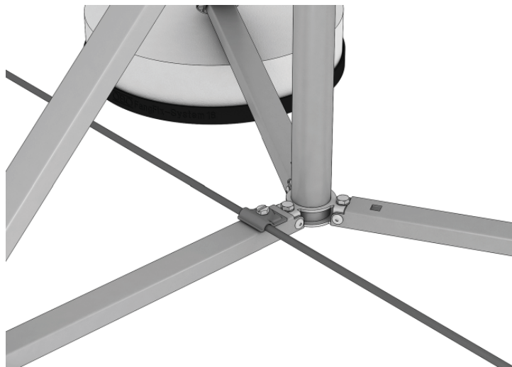
Bild 33 Nicht-isolierten Fangmastständer an Blitzschutz-Anlage anschließen
