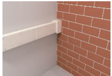
Ein Wandanschlusskragen I 90 ist erforderlich bei der Wanddurchführung des Kanals. Die einzelnen Plattenteile werden nur auf den Kanal aufgeschraubt.
