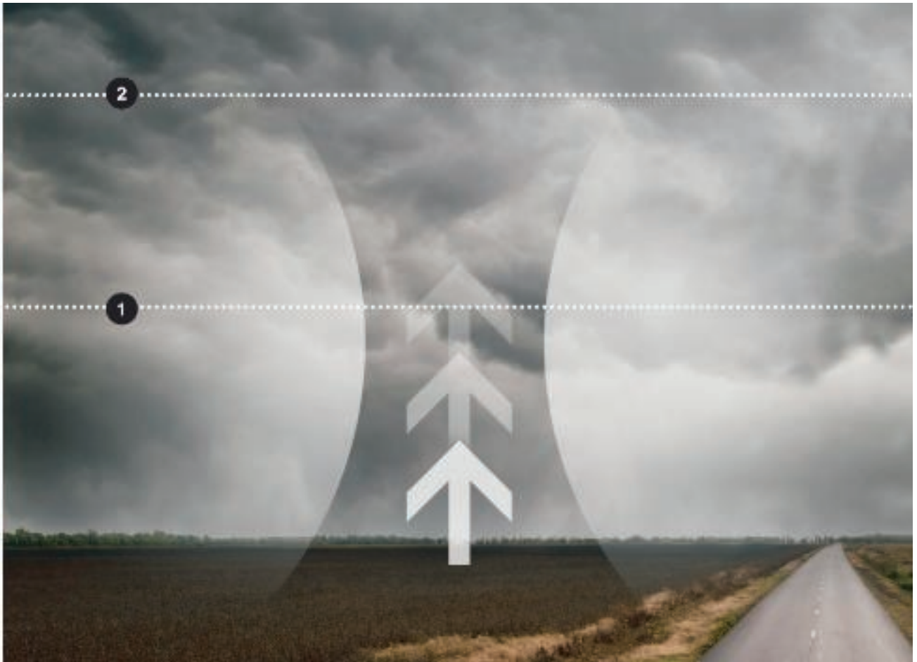
Žaibo iškrovų atsiradimas: 1 = maždaug 6000 m, maždaug -30^{\circ}\text{C} , 2 = maždaug 15000 m, maždaug -70^{\circ}\text{C}
