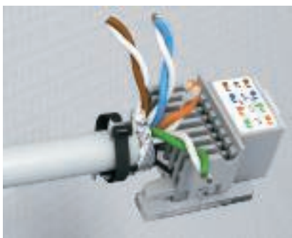
Prietaiso prijungimas - apsauga nuo laidų ištraukimo Kabelį įkiškite į kabelio užspaudimo elementą ir pridėta kabeline apkaba apsaugokite nuo ištraukimo. Jei kabeliai yra ekranuoti, reikia atkreipti dėmesį į tai, kontaktinis elementas būtų sujuntas su ekranu.
