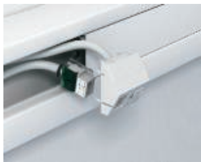
Duom.perdav.elementų laikiklių montavimas - prietaiso įmontavimas Paruoštą duomenų lizdą iš galo įstatykite į atitinkamą plokštelę. Tam į užspaudimo mechanizmą įkiškite modulio laikomąją plokštę ir užfiksuokite.
