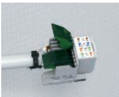
Prietaiso prijungimas - kabeliomontavimas Kontaktinę apkabą uždėkite ant jungiamojo modulio ir užfiksuokite. Jei konstrukcija yra ekranuota, papildomai reikia izem. ekrano korpusą.
