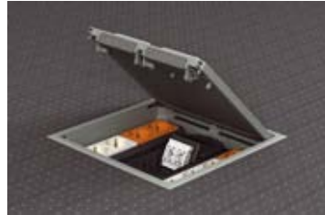
Lattiarasiat GES...U ovat 4mm:n teräslevyllä vahvistettua PA-muovia (polyamidi). Kannessa on 5mm:n upotusaukko lattiapinnoitteelle. Vakioväri on harmaa RAL7011. Muut värit ovat musta RAL9011, ruskea RAL8014 ja beige RAL1019.
