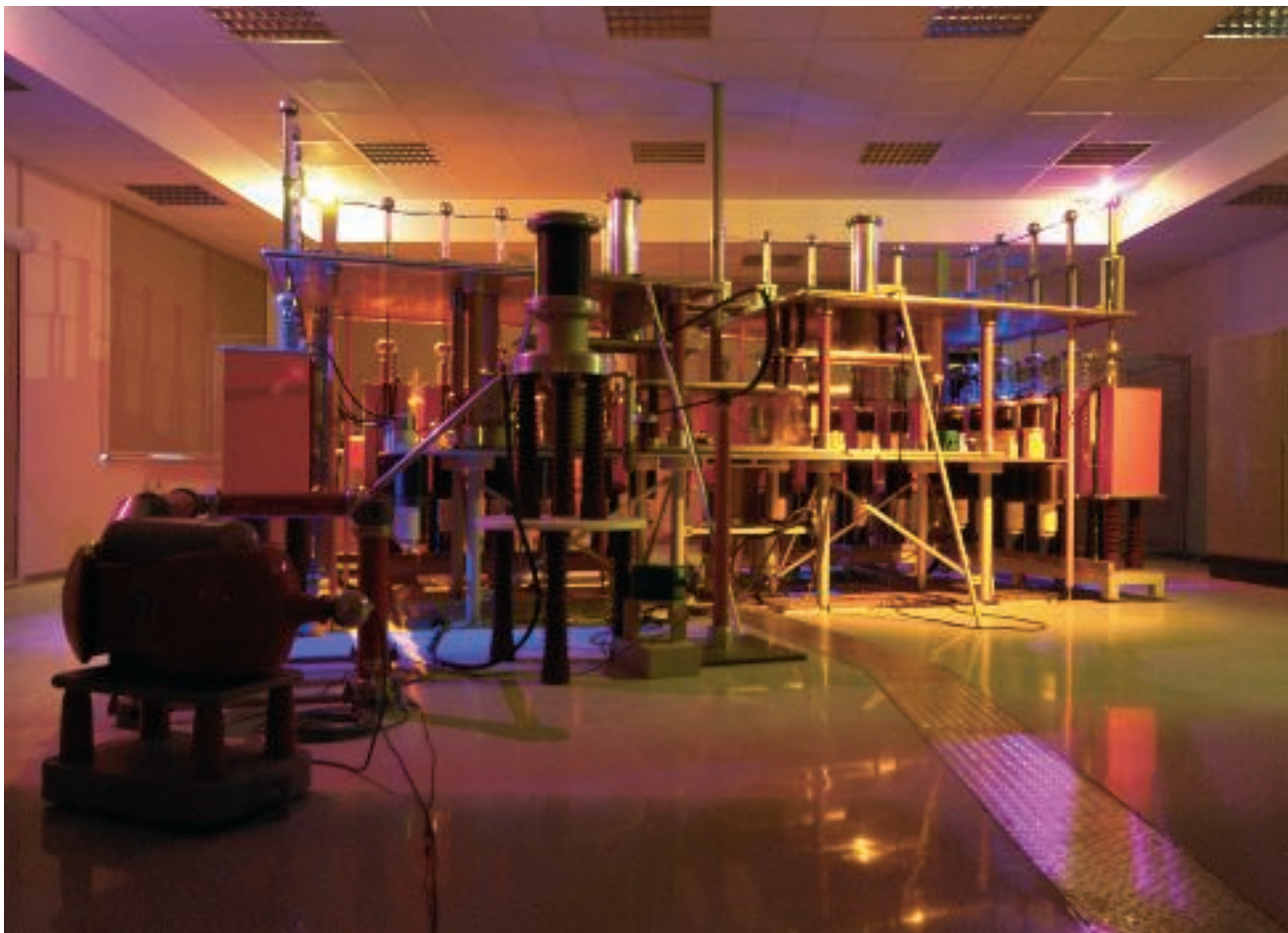
Ensayo de corriente de rayo
