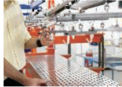
Prueba de sobrecarga
