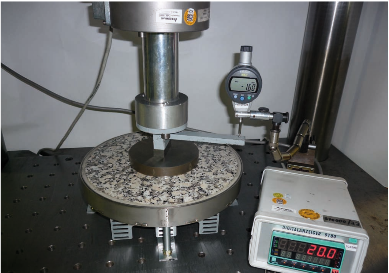
Bild 1: Belastungsprüfung einer Schwerlastkassette mit 20 kN
