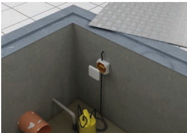
Bild 1: Anwendung von AQUASIT bei einer Installation in einem Pumpensumpf
