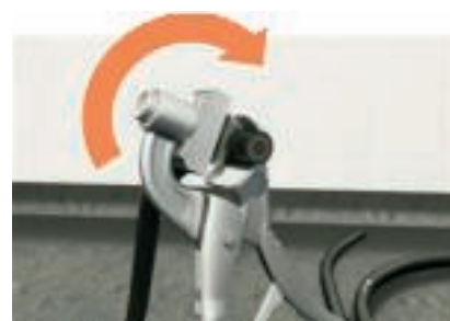
3. Nasadte kleště a po 25 mm nařízněte plášť, poté je otočte o 360 stupňů
