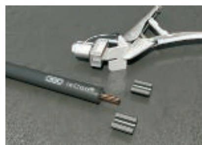
6. Otočením kleští uvolněte vnější plášť
