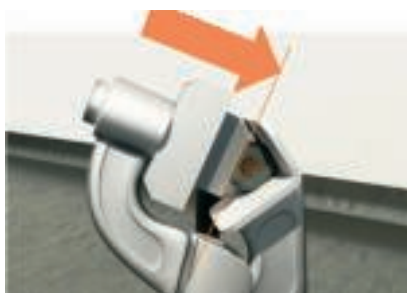
2. Nastavte hloubku řezu kleští (nesmí dojít k naříznutí měděného jádra)
