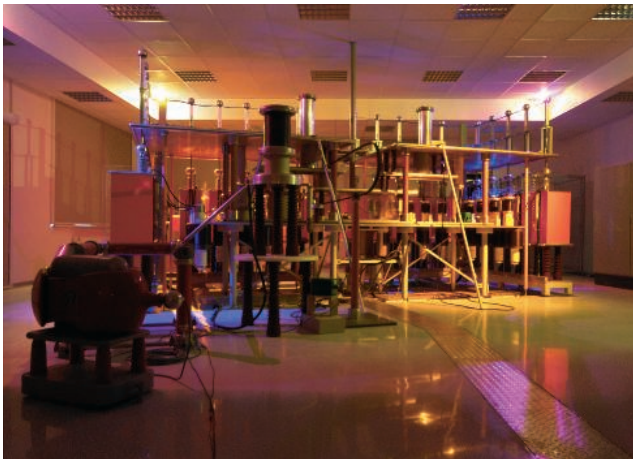
Zkoušení bleskovým proudem
