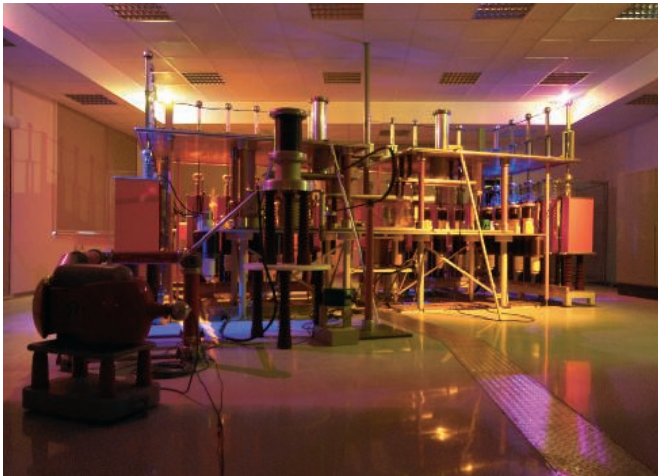
Zkoušení bleskovým proudem
