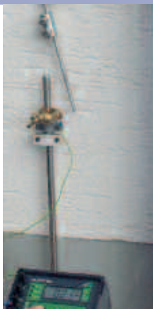
Měření odporu uzemnění
